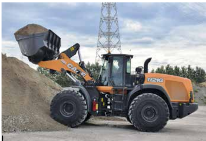
De penhoogte van de laadframe reikt tot 4,45 m en de maximale kiplast (rechtuit) ligt op 23.580 kg.
