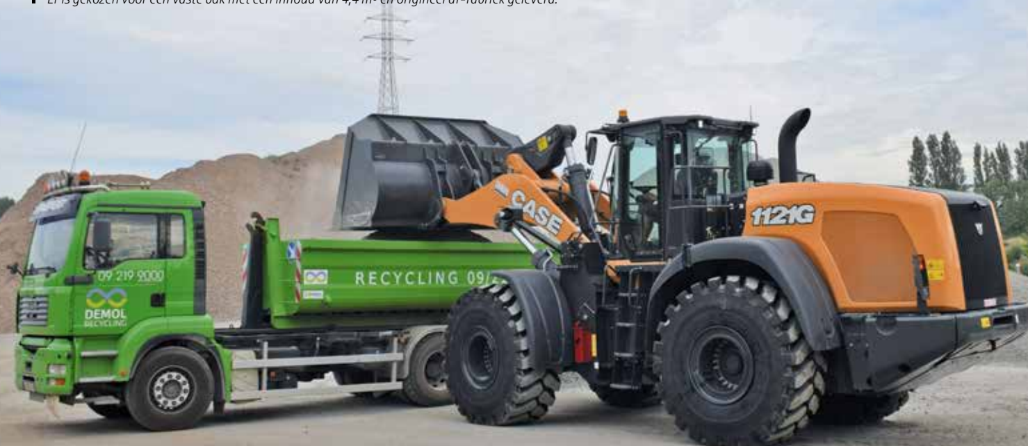
Er is gekozen voor een vaste bak met een inhoud van 4,4 m 3 en origineel af-fabriek geleverd.
