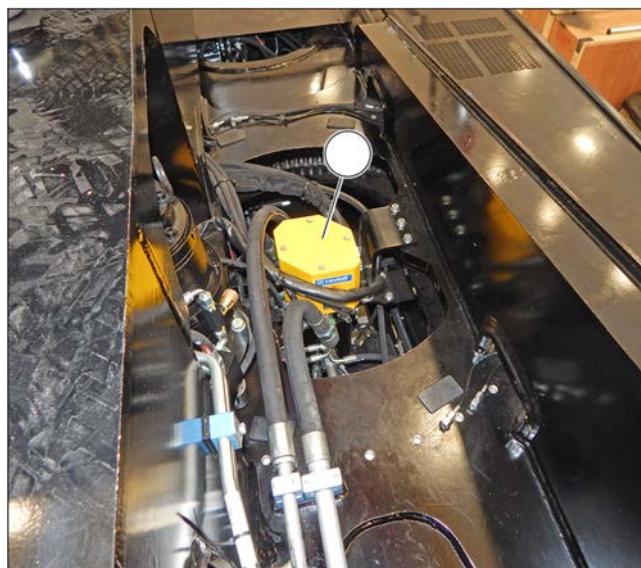
Afbeelding 224: De zenderringen van de roterende elektrische collector controleren en reinigen
