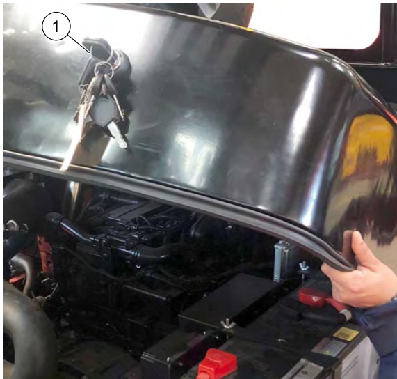
Afbeelding 37: Sleutel in motorkapslot
