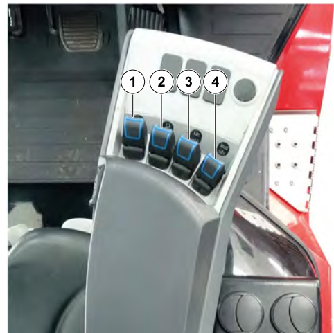
Afbeelding 30: Hydraulische bediening met minihendels
