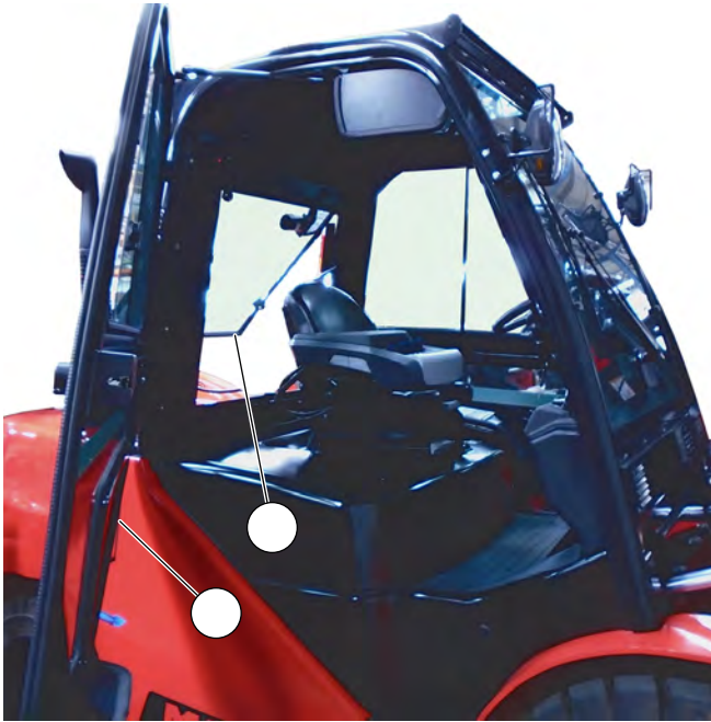
Afbeelding 36: Motorkap openen bij uitvoering met cabine
