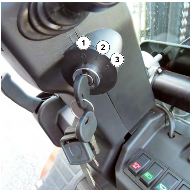
Afbeelding 24: Standen van de contactschakelaar
