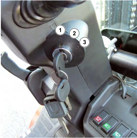
Afbeelding 23: Standen van de contactschakelaar
