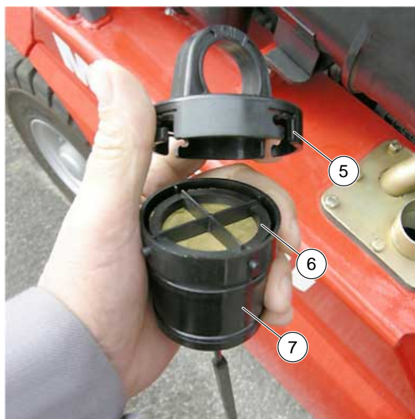
Afbeelding 87: Reiniging van de filterplug
