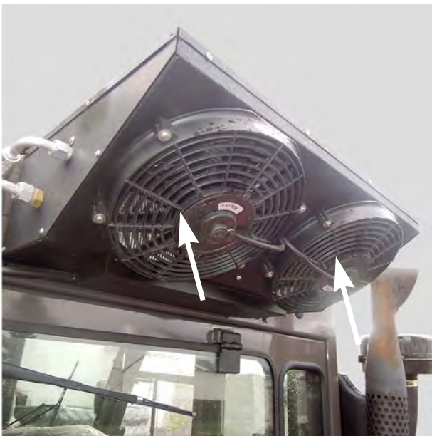
Afbeelding 61: Richting van de persluchtstroom door het condensorblok van de klimaatregeling
