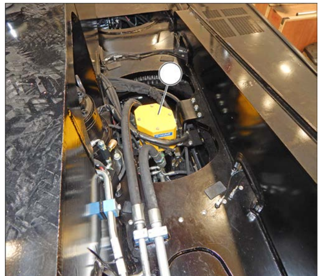
Afbeelding 224: De zenderringen van de roterende elektrische collector controleren en reinigen
