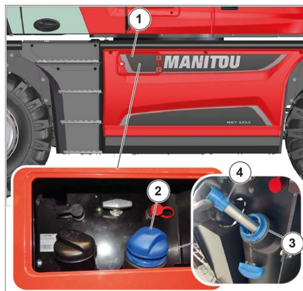
Afbeelding 226: Het filter van de vulopening van het DEF-reservoir controleren en reinigen
