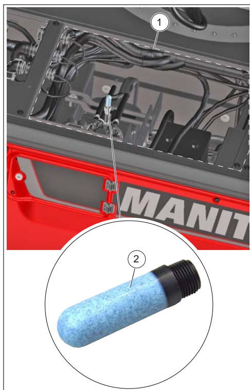
Afbeelding 205: De ontluchter van de DEF-tank vervangen
