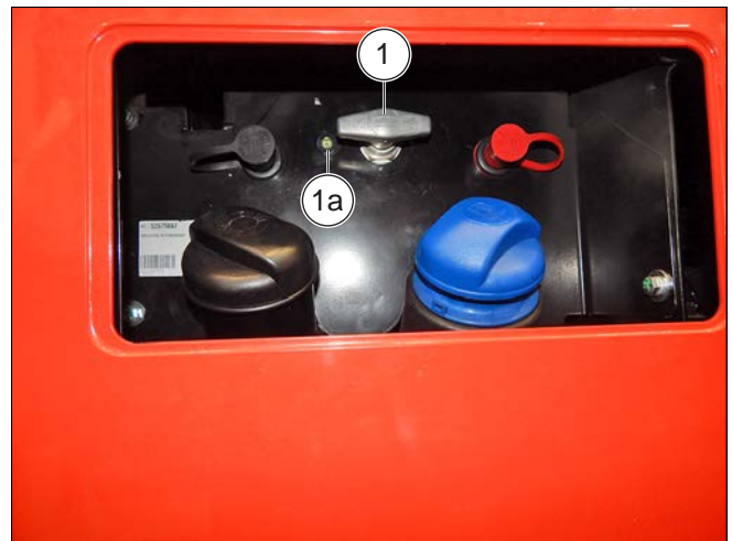
Afbeelding 66: Schakelaar voor ont koppeling van de accu
