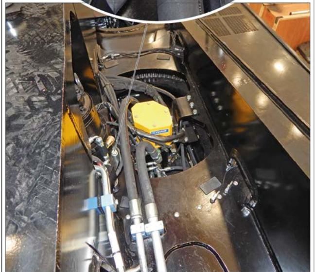
Afbeelding 166: De bevestiging van de bevestigingsschroeven van de rotatiereductor controleren
