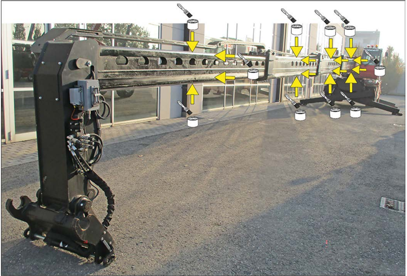
Afbeelding 156: De slijtplaten van de telescooparm reinigen en smeren
