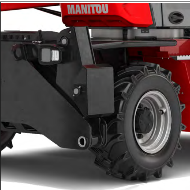
Afbeelding 226: Wegverkeer - Stabilisatoren volledig gesloten (MRT 2145 - MRT 2545)
