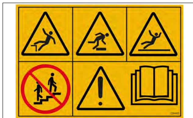
Afbeelding 17: Sticker - Gevaar Het is verboden de trap op of af te gaan
