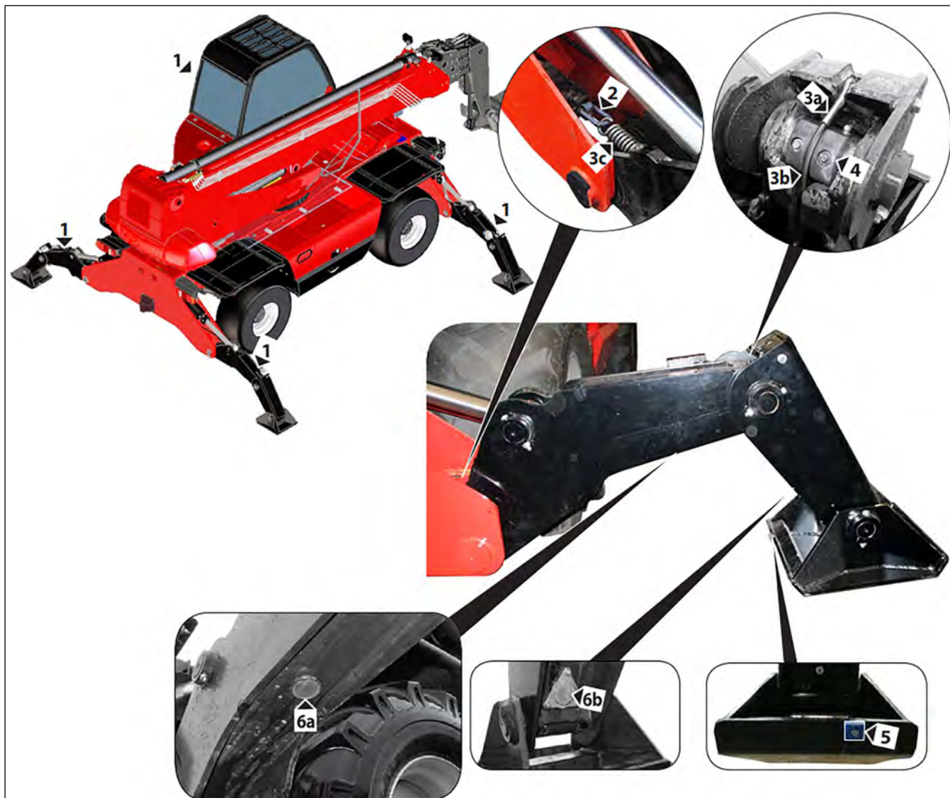
Afbeelding 260: Het daal- en hefsysteem voor de stabilisatoren controleren
