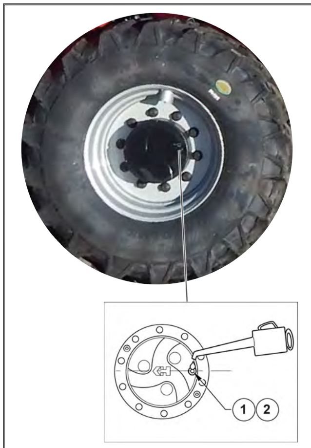
Afbeelding 252: Oliepeil van voor- en achterwielreductoren controleren
