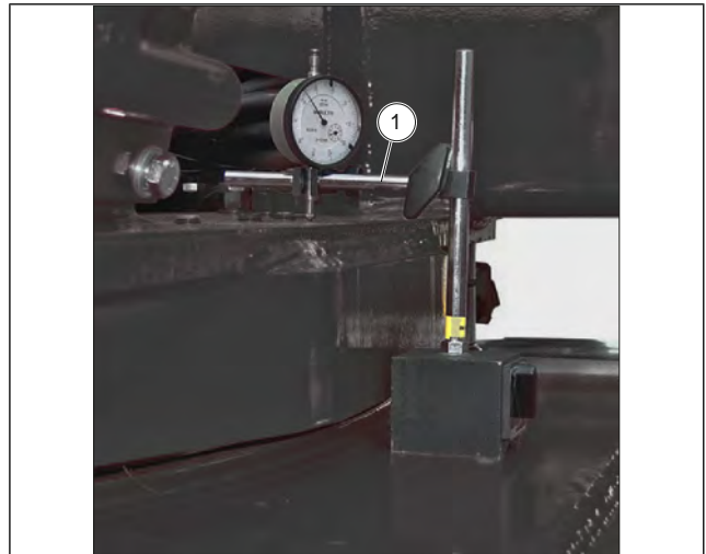
Afbeelding 285: Op slijtage en meer speling in de lagers van de koppelschotel controleren
