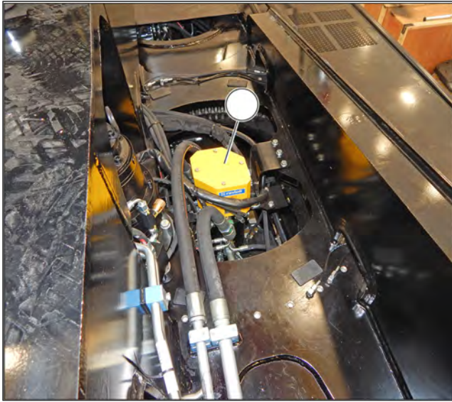
Afbeelding 307: De zenderringen van de roterende elektrische collector controleren en reinigen
