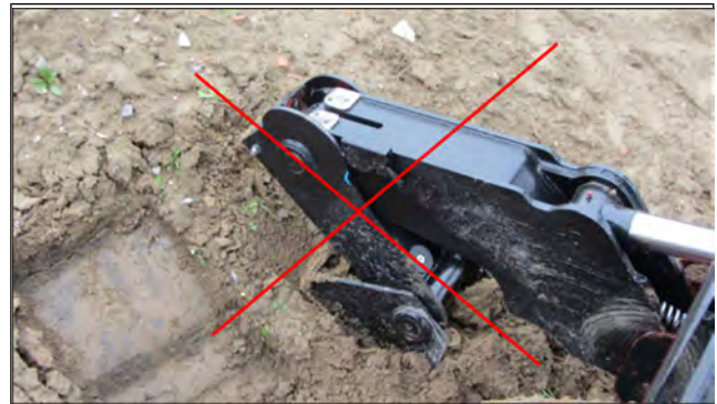
Afbeelding 224: Controleer de juiste opening of uitschuiving van de stabilisatoren.
